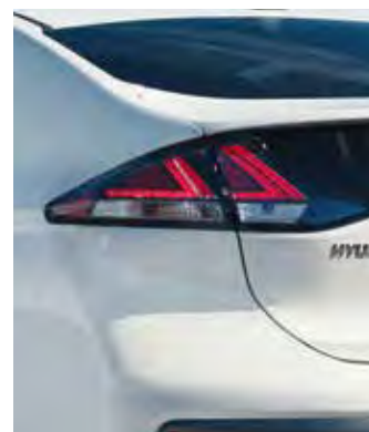
Blocuri optice spate
